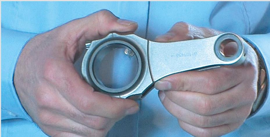
Titanwerkstoffe werden dort eingesetzt, wo Gewicht eingespart werden muss. Sie sind leichter und zugfester als Stahl.
