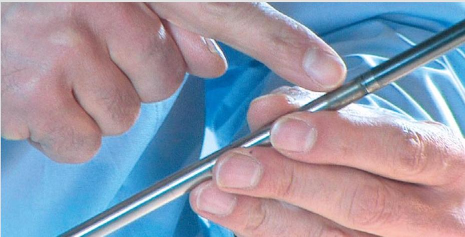
**Problemstellung:** In der Batterieherstellung werden Pressstempel eingesetzt, die bei der Befüllung als Platzhalter für den Kohlekern dienen. Mechanischer Verschleiß und Korrosion durch Chemikalien verringern den Stempeldurchmesser. Der Platz für den Kohlekern wird zu klein.
