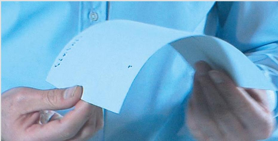
Die von ISOTEC entwickelte Keramikfolie ist einzigartig. Das mikroporöse Material ist flexibel und bei Temperaturen bis 1.000 °C einsetzbar.
